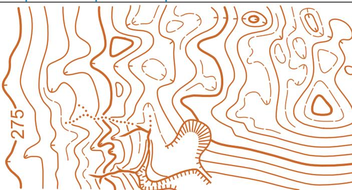
Рельеф местности показывается с помощью горизонталей и специальных УЗ для внемасштабных объектов и т. д., и может дополняться УЗ скал и камней черного цвета.
